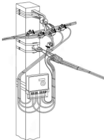
Внешний вид счетчика НЕВА СП3XX установленного на опору.
