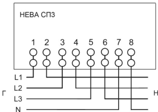
Схема включения счетчиков НЕВА СП3 непосредственно в сеть
