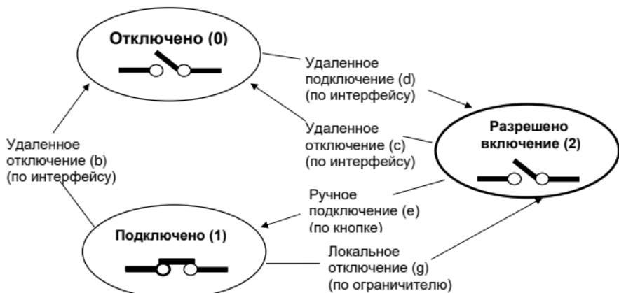
Рисунок 1.5 – Режим работы 3. Разрешены переходы б, с, е, г, д.
