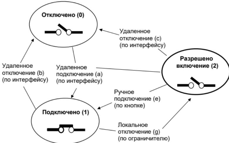
Рисунок 1.6 – Режим работы 4. Разрешены переходы а, б, с, е, г.
