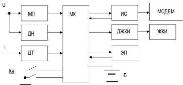
Рисунок 1.2 – Функциональная схема счетчика
