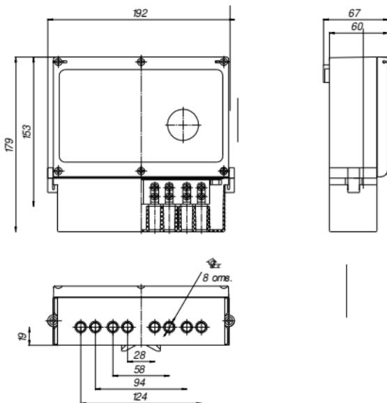
Внешний вид, габаритные и установочные размеры счетчиков НЕВА СП3.
