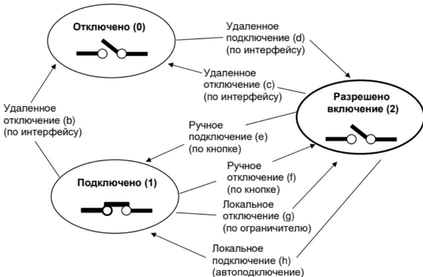
Рисунок 1.7 – Режим работы 5. Разрешены переходы б, с, д, е, ф, г, х.
