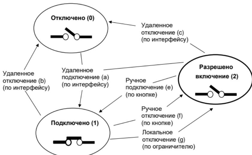
Рисунок 1.4 – Режим работы 2. Разрешены переходы а, б, с, е, ф, г.
