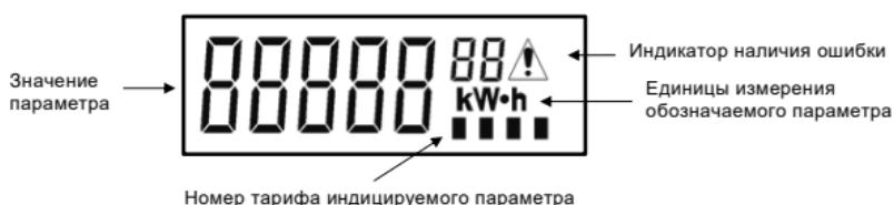
Рис. 2.1 Расположение информации на ЖКИ
